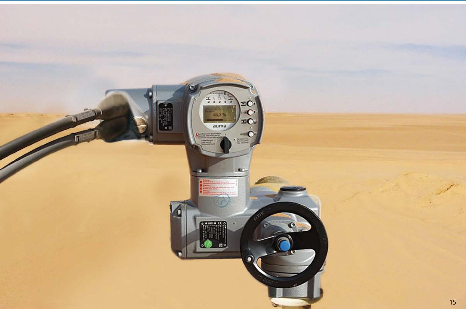
La protection anti-corrosion AUMA est un facteur décisif pour la longue durée de vie des appareils. Le système anti-corrosion pour servomoteurs AUMA est basé sur un traitement préliminaire chimique et un double revêtement par poudre des pièces individuelles. Des catégories de protection anti-corrosion AUMA basées sur les catégories de corrosivité atmosphérique selon EN ISO 12944-2 seront appliquées pour les divers types d'environnement.
