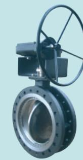
Valvola a farfalla a triplo eccentrico con tenuta metallo-metallo, DN 80 – 1400 in acciaio inox, Duplex e Super Duplex.
