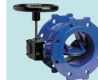
Valvola a farfalla a doppio eccentrico, DN 150 – 2200 in ghisa sferoidale rivestita. Duplex e dischi in leghe speciali a richiesta.
