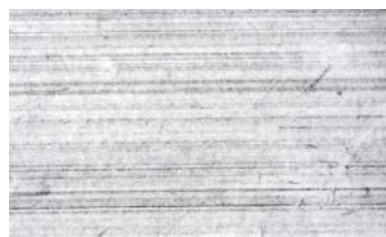
Surface d'une manchette ULTRAFLO ® non traitée (facteur de grossissement : 25 x)
