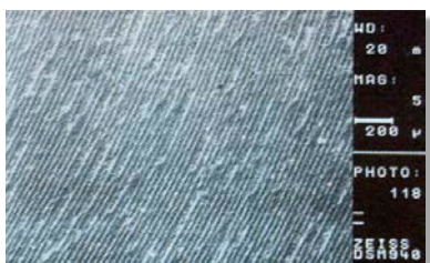
Superficie di un manicotto di tenuta in PTFE lavorato ingrandita 50 volte
