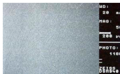
Superficie di un manicotto di tenuta in ULTRAFLO ® lavorato ingrandita 50 volte
