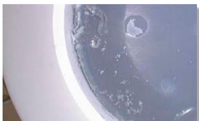
Abrasione con un manicotto di tenuta convenzionale in PTFE
