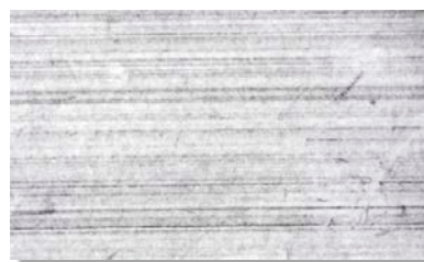
Superficie di un manicotto di tenuta in ULTRAFLO ® non lavorato ingrandita 25 volte
