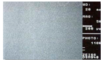
La superficie de un asiento de ULTRAFLON® mecanizado y aumentado 50 veces
