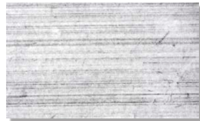
La superficie de un asiento de ULTRAFLON® sin mecanizado aumentada 25 veces
