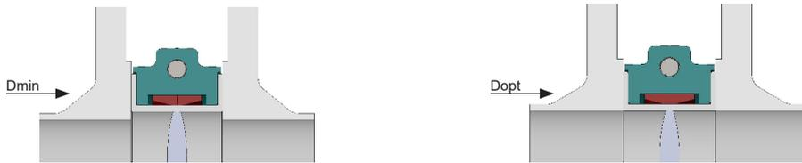
Dmin Minimal erforderlicher Innendurchmesser der Flansche, um eine fehlerlose Betätigung der Klappenscheibe zu gewähren (in diesem Fall muss die Klappe optimal zentriert sein).
