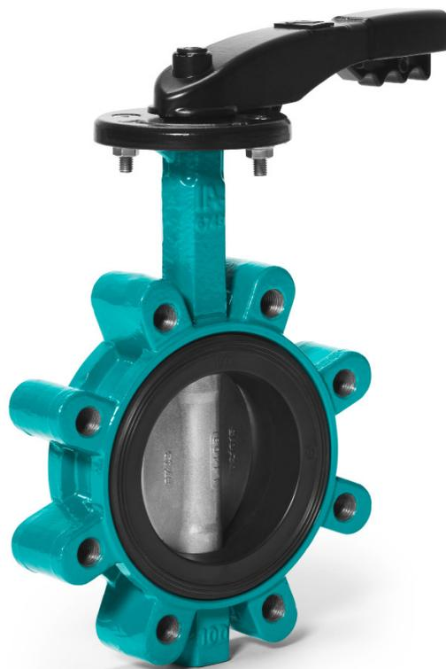
Desponia® et Desponia® plus, de DN 50 à DN 250 et une pression de travail jusqu'à 5 bar, ont satisfait aux exigences rigoureuses de la norme EN 161 et ont obtenu l'approbation du DVGW, conformément à la norme EN 161 Classe A, groupe de vannes 2, classe de sécurité B. En outre, ils répondent également à l'une des normes les plus importantes en matière d'émissions fugitives, TA-Luft/VDI 2440 et peuvent être fournis avec une exécution ATEX.
