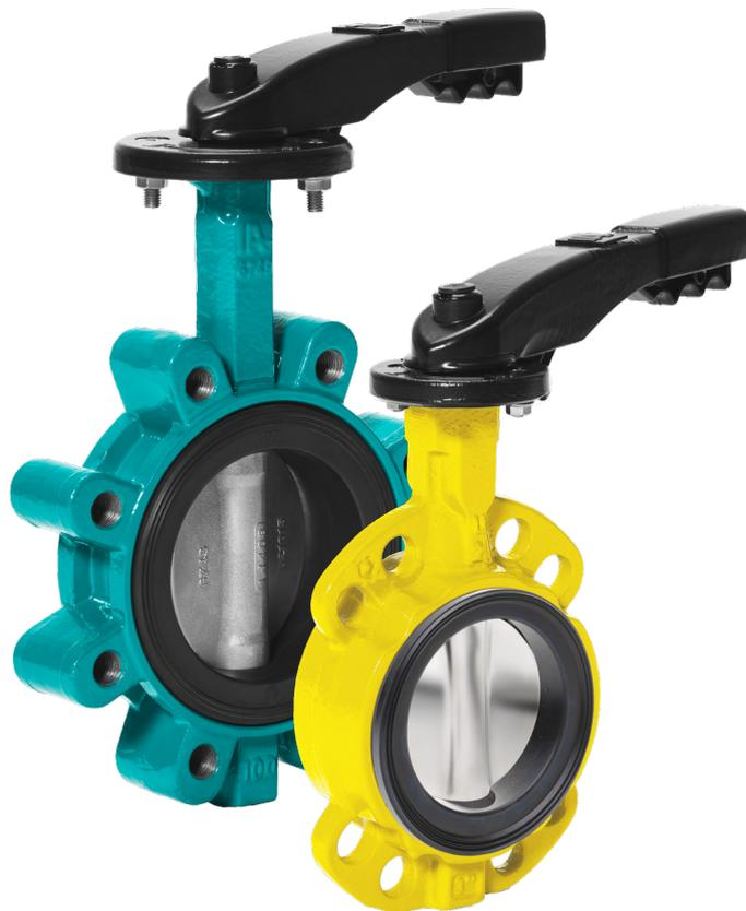
Desponia® et Desponia® plus, de DN 50 à DN 250 et une pression de travail jusqu'à 5 bar, ont satisfait aux exigences rigoureuses de la norme EN 161 et ont obtenu l'approbation du DVGW, conformément à la norme EN 161 Classe A, groupe de vannes 2, classe de sécurité B. En outre, ils répondent également à l'une des normes les plus importantes en matière d'émissions fugitives, TA-Luft/VDI 2440 et peuvent être fournis avec une exécution ATEX.
