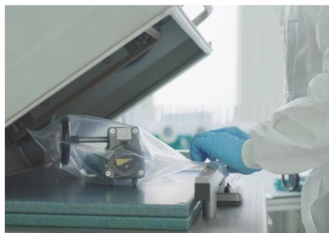
Чистое помещение регулярно убирается, состояние воздуха строго контролируется, а рабочие на протяжении всего производственного процесса носят специальную рабочую одежду и чистые латексные перчатки.
