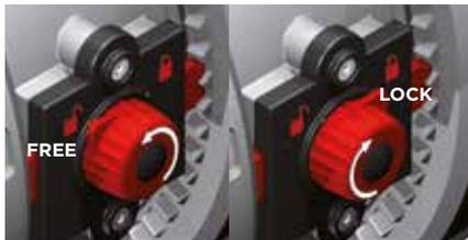
Ruotando il pulsante verso sinistra e orientando la freccia sul lucchetto aperto si mette il DUAL BLOCK® in posizione di sblocco: le ghiera della valvola sono libere di ruotare in senso orario ed antiorario.
