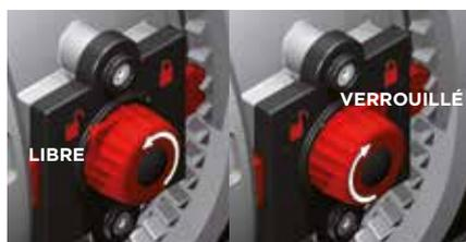
En tournant le bouton vers la gauche et en orientant la flèche sur le cadenas ouvert, on déverrouille le DUAL BLOCK® : les écrous union du robinet sont libres de tourner dans le sens horaire et dans le sens contraire.
