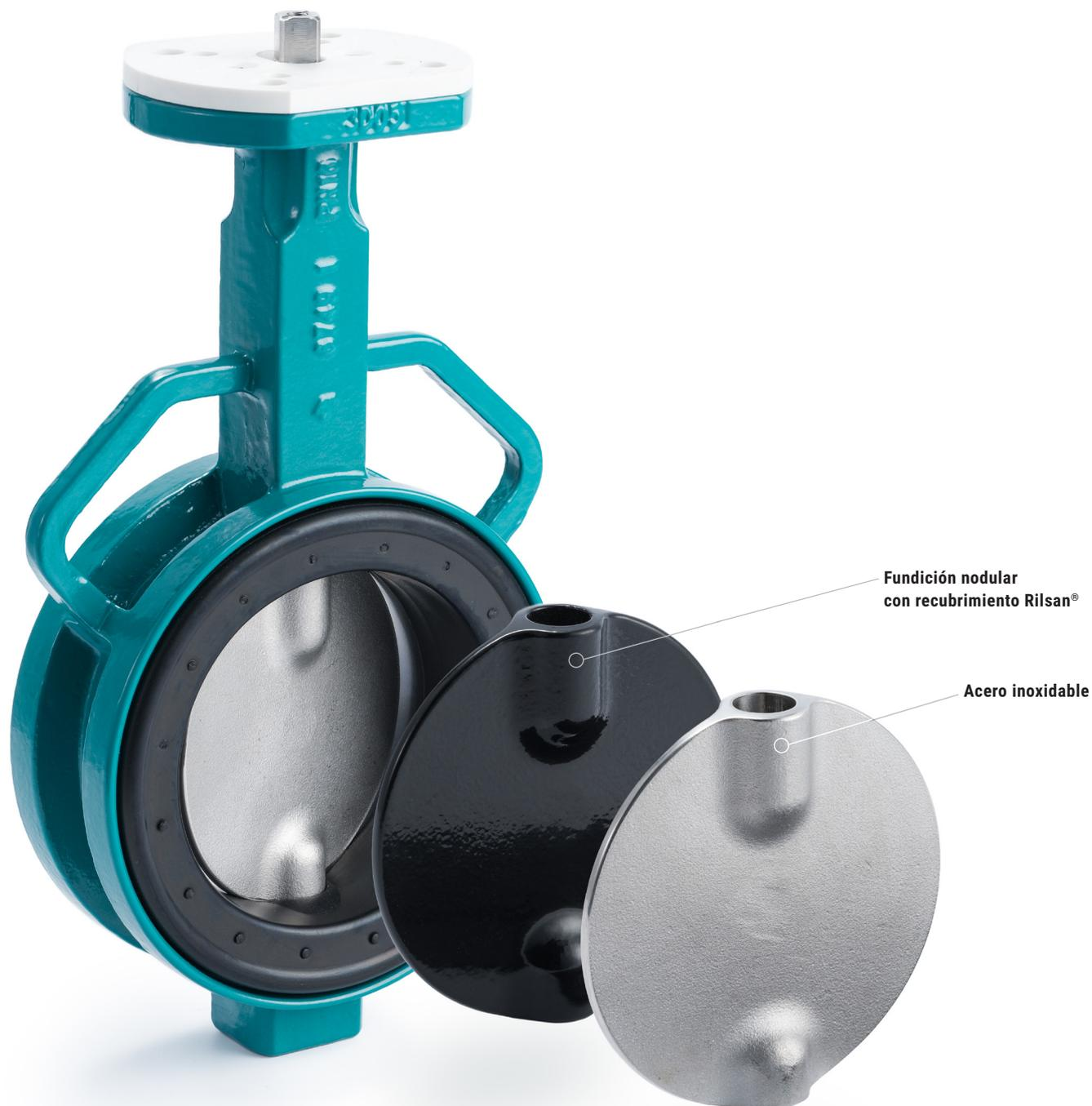
Con disco en fundición nodular para aplicaciones de regadío o el disco apropiado para aplicaciones de HVAC y piscinas, la válvula de mariposa
