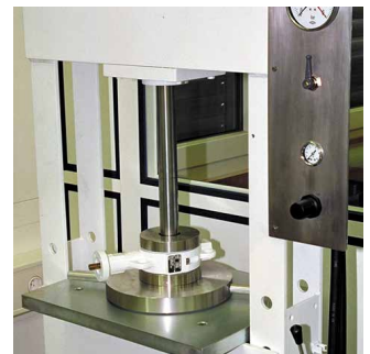
超纯空气中的密封性测试
