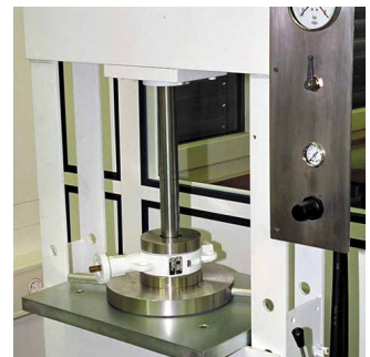
超純空氣中的密封性測試
