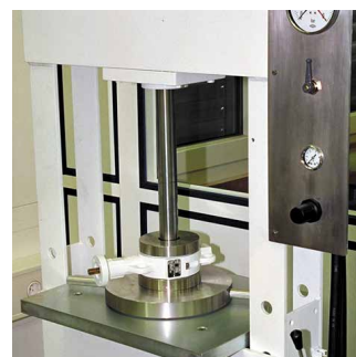
Próby szczelności ultraczystym powietrzem
