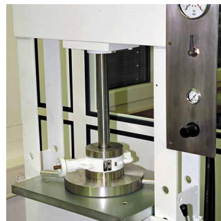
Испытания на герметичность и прочность сверхчистым азотом
