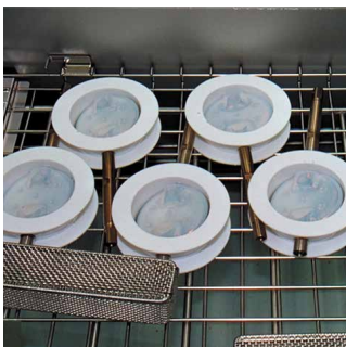
Мойка комплектующих деталии сверхчистой водой
