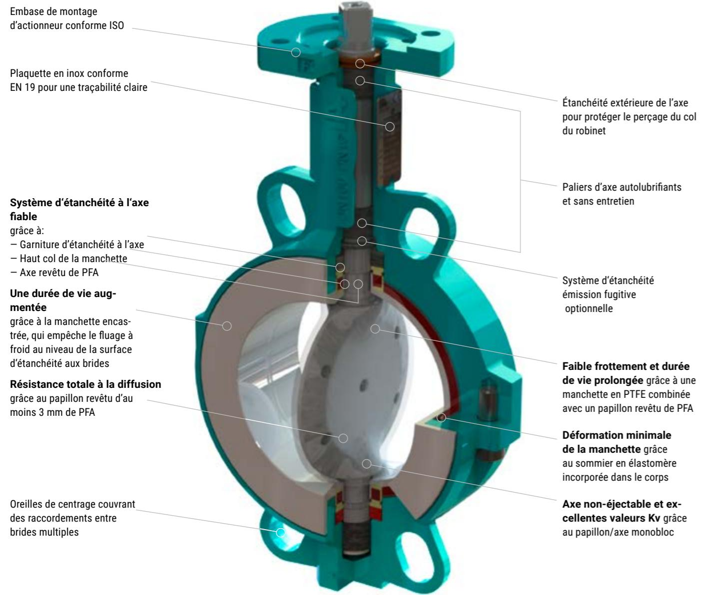
Le haut col de la manchette, le papillon revêtu de PFA sur l'axe ainsi que la garniture d'étanchéité à l'axe préchargé à vie garantissent non seulement une excellente étanchéité primaire, mais aussi une étanchéité secondaire durable à l'axe, même à des fréquences de manœuvre élevées et à haute température.
