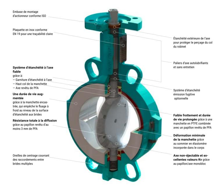
Le haut col de la manchette, le papillon revêtu de PFA sur l'axe ainsi que la garniture d'étanchéité à l'axe préchargé à vie garantissent non seulement une excellente étanchéité primaire, mais aussi une étanchéité secondaire durable à l'axe, même à des fréquences de manœuvre élevées et à haute température.
