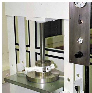
Испытания на герметичность и прочность сверхчистым азотом
