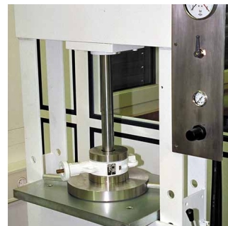
Test d'étanchéité avec air ultrapure
