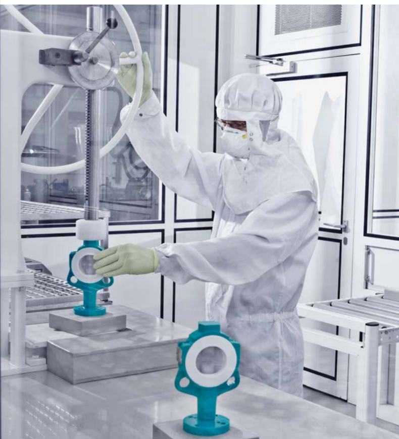
Montage der Bianca Absperrklappe im Reinraum
