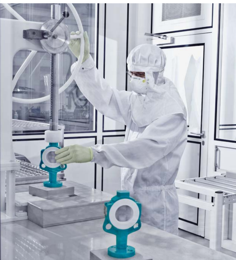
Montage des robinets à papillon en salle blanche
