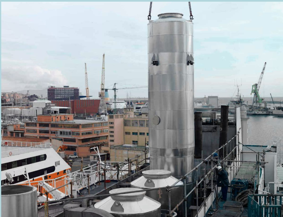
Système marin DeSOx (Image : avec l'aimable autorisation d'Ecospray Technologies)
