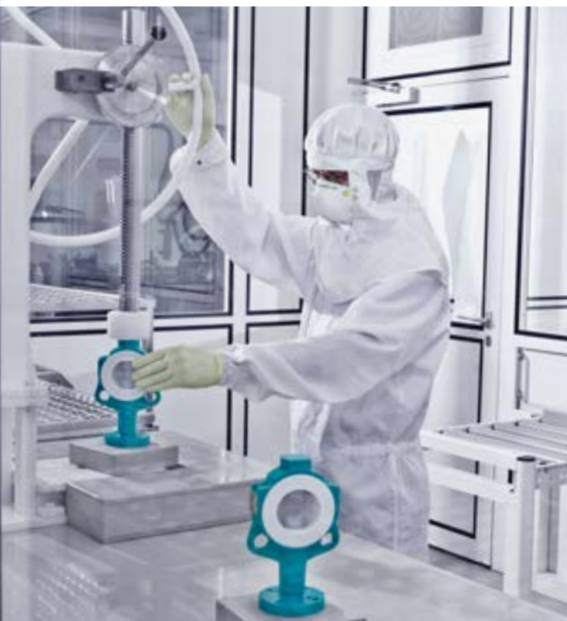
Montage der Bianca Absperrklappe im Reinraum
