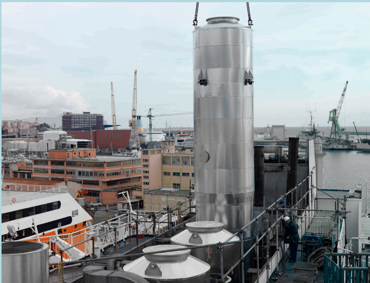
Sistema Navale DeSOx (Immagine: Cortesia di Ecospray Technologies)
