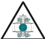
Las bridas ha de estar suficientemente separadas para que la válvula entre sin dificultades con el disco ligeramente abierto.(Fig.6) En caso contrario, puede dañarse el asiento a introducir la válvula entre las bridas.
