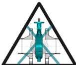
Die Klappe darf unter keinen Umständen zwischen Flanschen, die nicht parallel zueinander sind, eingebaut werden. Die Achsen der Rohrleitungen und Klappen müssen fluchtend sein. Die Scheibe einer versetzten Klappe könnte beschädigt werden. (Fig.5). Ausserdem ist es absolut unzulässig an der Rohrleitung zu schweissen, solange die Klappe sich zwischen den Flanschen befindet. Dies würde die Manschette der Klappe zerstören.
